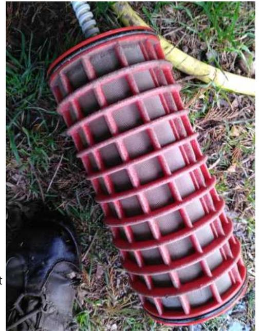
*Jeudi 15 au matin : plus d'eau dans les tuyaux ! 1h30 de travail pour identifier le problème, démonter, nettoyer, remonter le filtre, purger les tuyaux ensablés ! Les pluies du week-end passé ont mis en suspension beaucoup de sable dans le canal de Sorgues où je pompe l'eau...*
